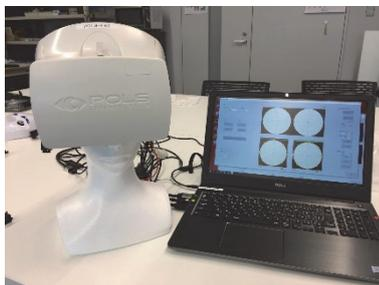
現在開発している視線情報を検出するEOGセンサとHMDを利用した新しい視野計測装置
