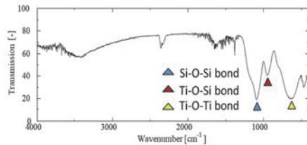
Ti-O-Si結合を多く持つ光触媒用チタニアシリカ複合粒子
