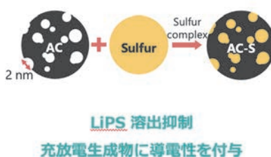
ミクロ多孔性カーボン(AC, 細孔径 &lt; 2 nm) に硫黄を複合
