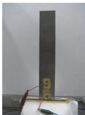
片持ちはりの振動制御の実験装置と測定結果 (受動制振およびハイブリッド制振)
