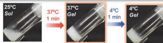
図1 温度上昇とともに即座にゲル化し、低温にしてもゾル状態に戻らない：不可逆的なゲル化を示す。
