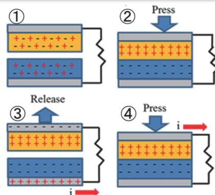
図1. 摩擦発電の原理
