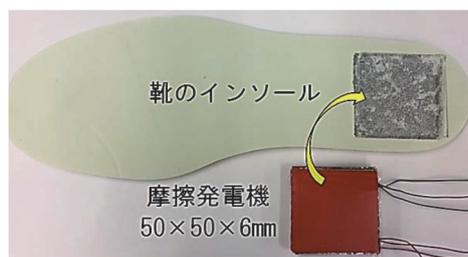
図2. インソール組込み摩擦発電機
