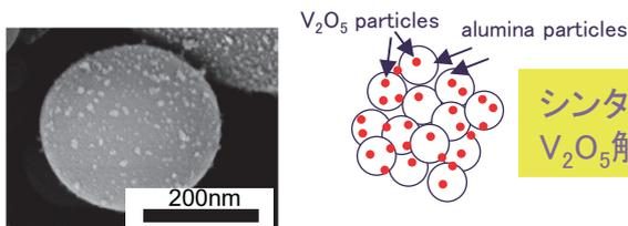
シンタリングしないV<sub>2</sub>O<sub>5</sub>触媒粒子
