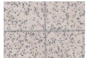
藻類の細胞壁破壊
