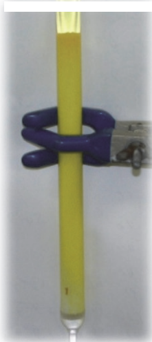
希薄水溶液からのCr(VI)の連続除去装置
