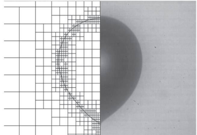
複雑な条件を持つ粘弾性流体中気泡の数値解析(左)と実験(右)の気泡形状が一致。
