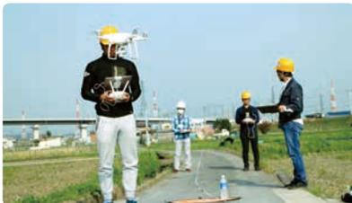
2台のドローンでバッテリー交換による撮影中断の影響を最小化するための検証
