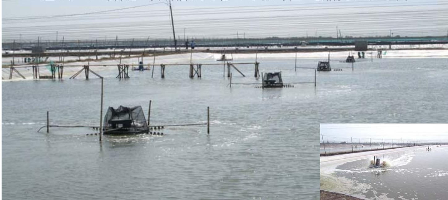
5,000㎡の池に遠心式攪拌機を並列で4台設置した実用テストの様子 (右下) 同規模池に大出力の水車式攪拌機を10台設置している様子
