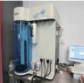
高精度・多検体ガス吸着量測定装置
