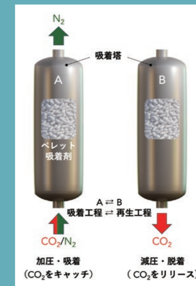
CO 2 をはじめ、窒素(N 2 )や酸素(O 2 )などのさまざまなガスをゼオライトに供給し、吸着・脱着度をシミュレーションする
