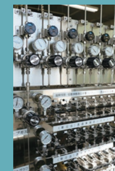
CO 2 をはじめ、窒素(N 2 )や酸素(O 2 )などのさまざまなガスをゼオライトに供給し、吸着・脱着度をシミュレーションする
