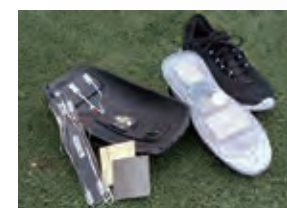
▲摩擦発電を利用したインテリジェントタイヤ（左）とウェアラブルデバイス（靴）（右）
