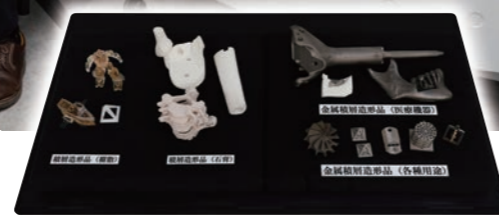
▲積層造形の種類。材料は左から樹脂、石膏、右が金属。すでに人工関節などでは実用化が進んでいる。
