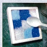
ガラスカレットはサヤの高さまでしっかり埋める。模様が出来たらスプーンで平らに整える。
