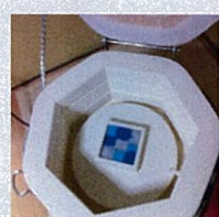
窯に入れて、約800度で焼き上げる。焼き上がり後、サヤから丁寧に外していく。
