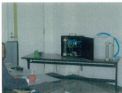
水溶性切削油の消臭装置 (プロトタイプ)
