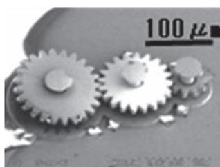
図29. 光造形により作製した歯車列
