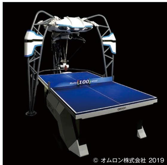
◀オムロン株式会社が開発した「フォルフェウス」。フォルフェウスは人に勝つためのロボットではなく、機械が人を理解し、人に合わせたインタラクションにより卓球技能を向上させ、人を育てるロボットである。
