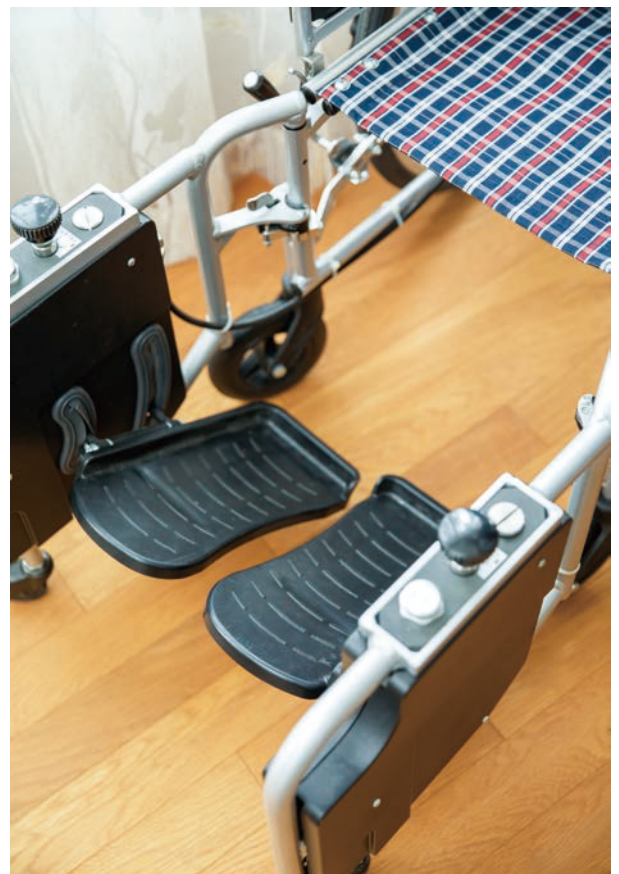
▶脚の筋力が弱くなってきた高齢者などを想定して開発されたトレーニング用車いす「Joyfum」。従来の車いすにはないステップを使用者自身が踏んで進むという分かりやすいインターフェイスで、海外の方からも好評を博している。使用者のQOLの向上を見据えた作りはもちろん、ポンプの中の水が押されて力を伝え、少しずつ進むため安全性も高い。
