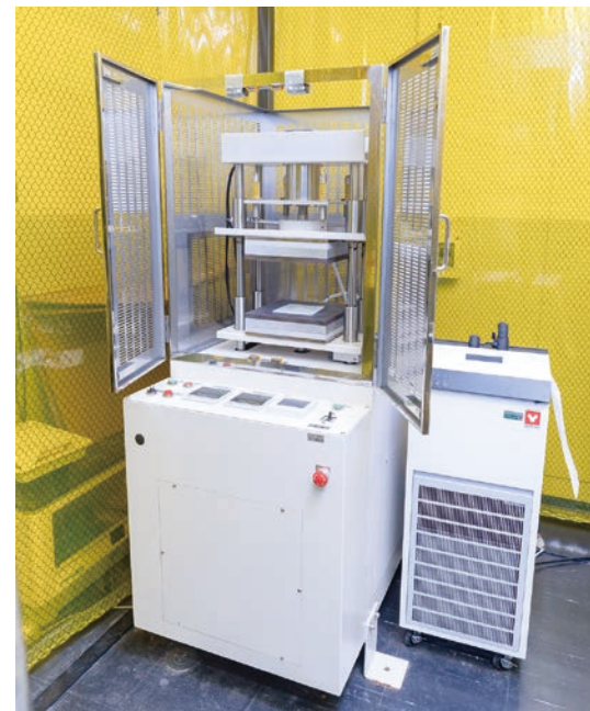
▲ナノ機能物理工学研究室の機械装置 この装置でナノスパイクを作製
