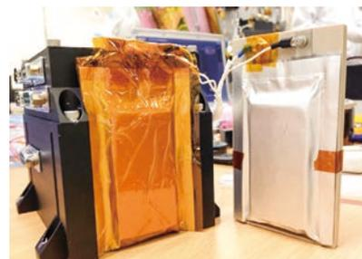
▲人工衛星搭載のラミネートセルと制御モジュール（背後の黒ブロック）
