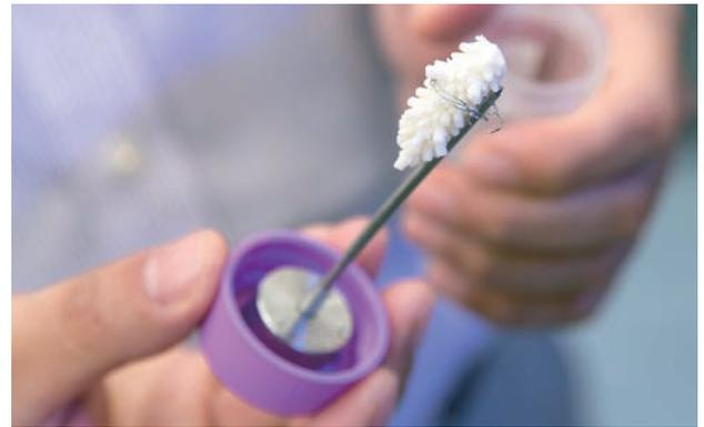
チタン棒表面におけるサンゴ骨格の形成過程を観察するための試料の一例。表面修飾を施したチタン棒にサンゴ片をステンレス鋼ワイヤーで固定した状態。海水に浸漬した状態で $\mu$ -CTによる撮像が可能。
