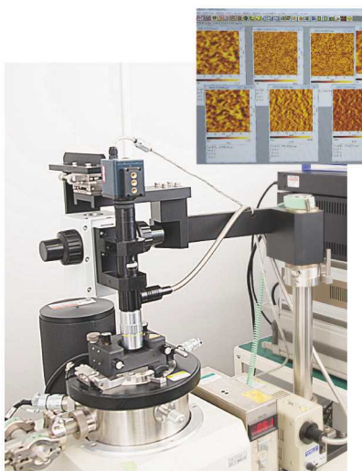
センシング材料として最適化するには、そのミクロな構造を制御する必要があります。その為、研究室では最先端の原子間力顕微鏡がフル稼働しています。
