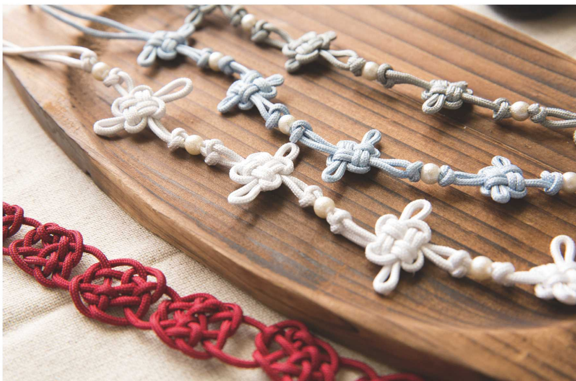
圧電組みひもに飾り結びを施し、アクセサリ型（チョーカー）に仕立てウェアラブルセンサ
