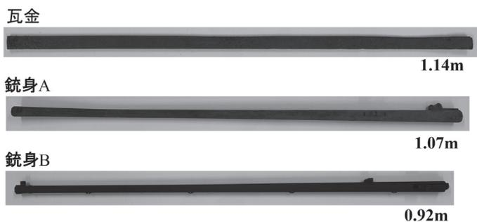
図1 供試材の銃身2本及び瓦金の外観
