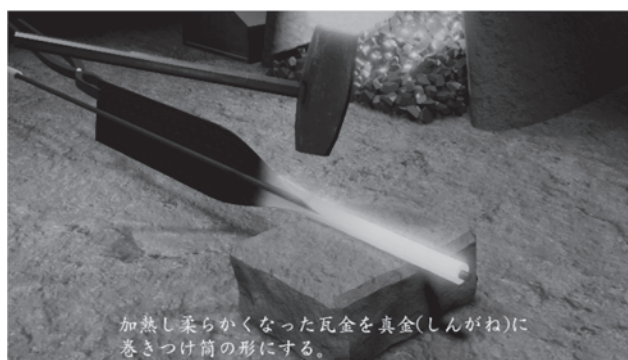
図3 工程a：鍛造による銃身の成形
