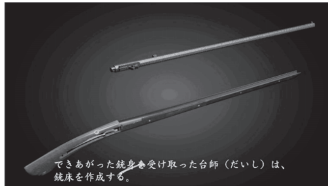
図9 製造工程Ⅳ：銃身、台木、からくりの組み立て
