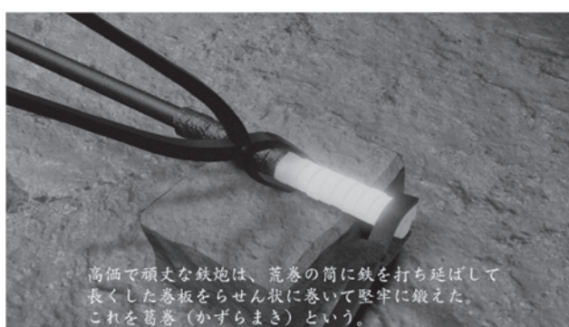
図4 工程b：葛巻による銃身の強化
