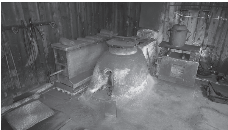
図14 現役の炉とフイゴ（水野鍛錬所）
