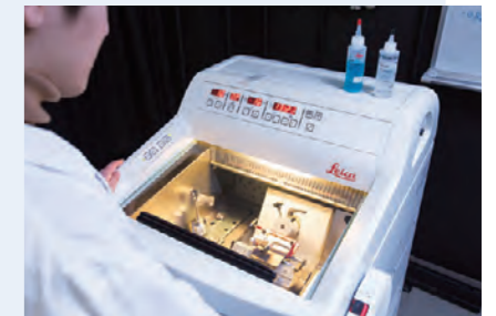
[i] クライオスタット (Leica CM1520 小型ルーチン用クライオスタット)
