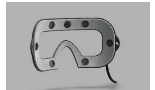
フェイス電極（眼電信号を検出する電極をマスク上に配置したもの）
