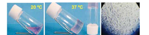
温度応答性インジェクタブルポリマー (機能性高分子研究室より提供)
