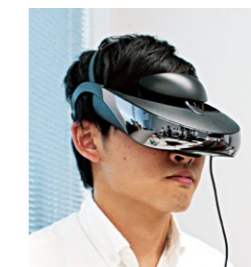
開発中のHMDを用いた視野検査システム
