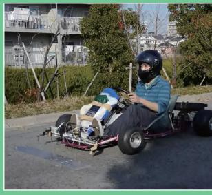
カート走行による路面凹凸測定実験
