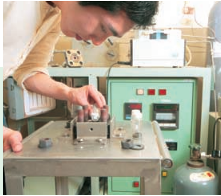
フロンガスなどの地球温暖化ガスを無害化する実験
