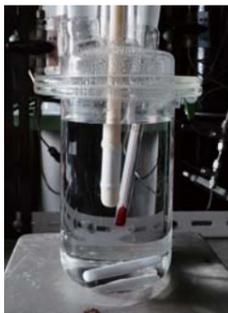
エネルギー・環境工学科の荒木貞夫助教は、さまざまな有機溶媒を含む廃水から有機物質を効率よく分離・回収する技術の開発を進めている。既存の疎水性分離膜の中ではトップクラスの透過流速と有機物選択性を実現。有機物と水の混合物の廃水処理や有機溶媒のリサイクルへの応用が期待される。
