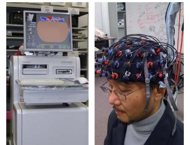
光トポグラフィ装置の計測・操作部分
