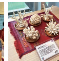
▲実際のサンゴ骨格から3Dプリントで製作されたサンゴ構造物
