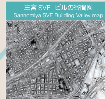
三宮 SVF ビルの谷間図 Sannomiya SVF Building Valley map SVF (Sky View Factor) によるビルの谷間と日射がよく当たる場所を抽出した図 Map showing building valleys and sunlit areas based on the SVF (Sky View Factor).
