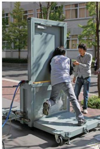
▲実物大ドア模型を用いた浸水時地下室からの避難体験実験
