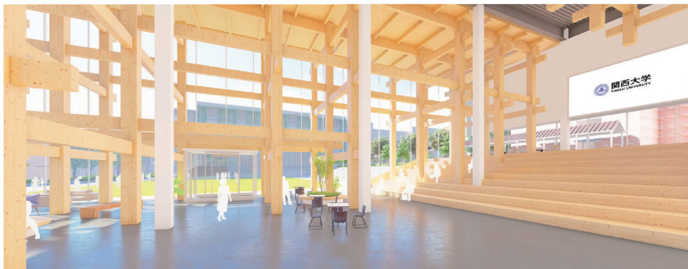
< エントランスイメージ／大屋根リングの木材をそのまま利用し、そこで使われていた木組みと貫工法を再現 >
