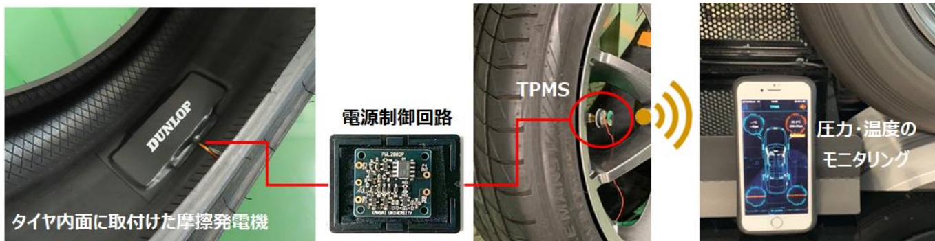
<今回開発したタイヤ組み込み用摩擦発電機>
