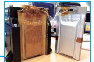
ほどよし3号機技術実証モジュールに搭載された石川教授らが開発したイオン液体リチウム二次電池
