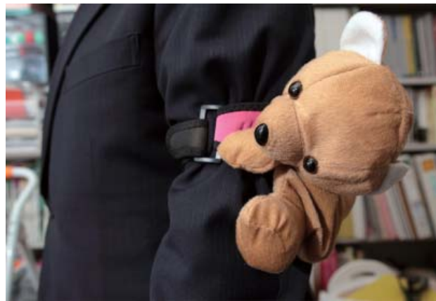
可愛いぬいぐるみの外見をした寄り添い型ウェアラブルロボット。内部に入れた振動モーター、圧力アクチュエータによって装着者へスキンシップ表現をする
