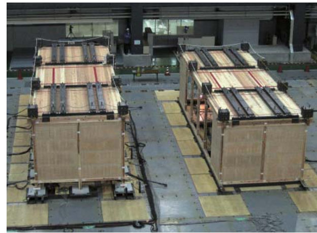
土台仕様試験体と足固め仕様試験体(右:土台、左:足固め仕様)
