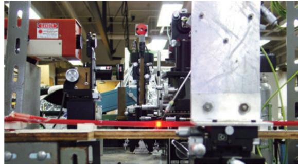
開発した光ファイバー血流速計で血流(水平な赤い管)を測る
