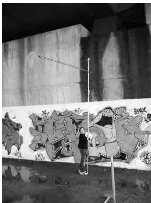
写真 1-4 物干竿の先端に CCD カメラをつけ、写真のようにカメラ台にしようとしたが、バランスが悪く失敗（必死に支える妻）。手前にはカメラ台を支えようとした杭とげんのう。
