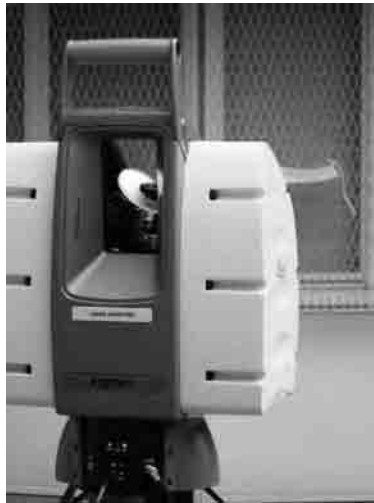
写真 1-20.21 この部分がレーザー光線を出しながら、一回転することで目に見える周辺をスキャンする。
