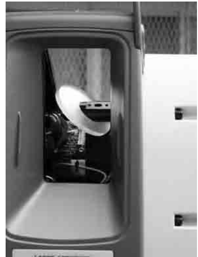
写真 1-20.21 この部分がレーザー光線を出しながら、一回転することで目に見える周辺をスキャンする。
