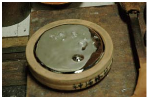
写真 41 ゴロタ入れ (型が吹いた状態)
