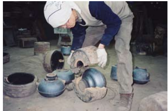
写真 49 外型（甲型）を2分割して外す
