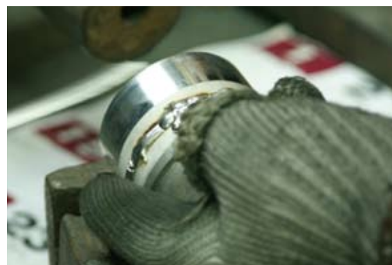
写真 75 仮止めの状態
