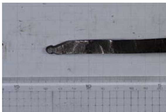
写真 65 クリガンナの例
