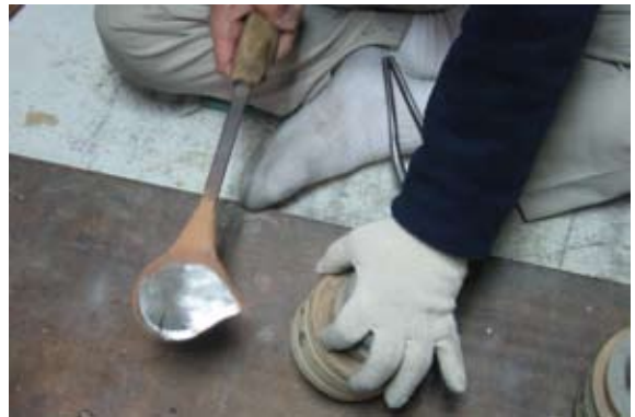
写真 44 杓でユを流し込む
