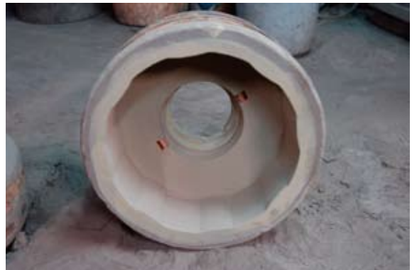
写真 27 多角形釜の鋳型
