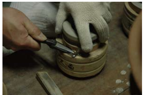
写真37 中子を回しながら持ち上げる
