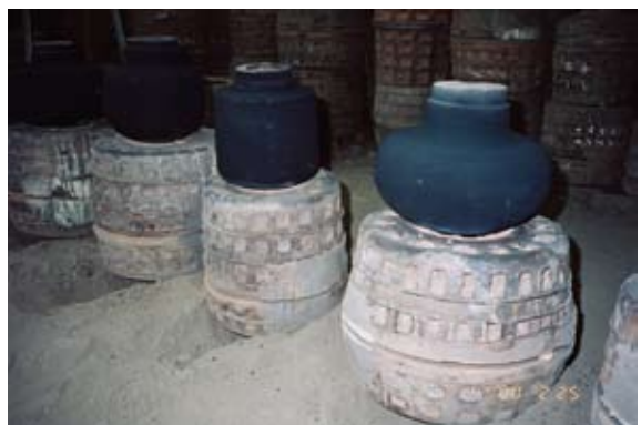
写真 37 外型と中子同時乾燥
