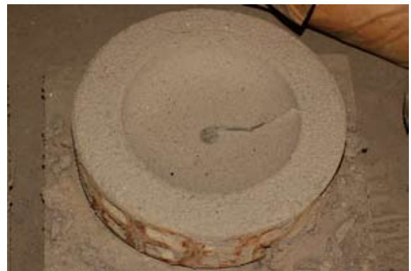
写真25 大粗挽き後の鑄型表面（尻型）
