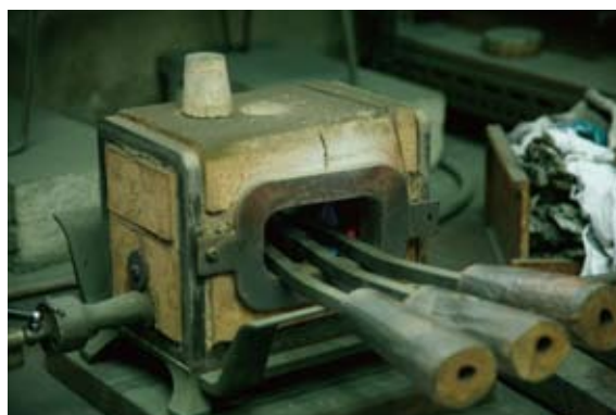
写真 73 コテを加熱する炉
