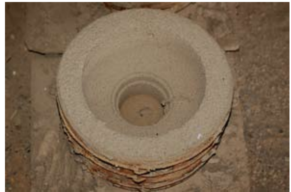
写真24 大粗挽き後の鑄型表面（甲型）
