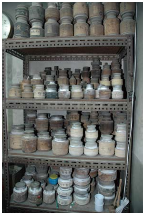
写真21 セメント型と真土型の収納棚
