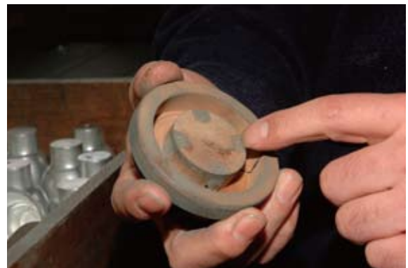
写真53 四爪ロクロのハメギの穴を埋めたもの
