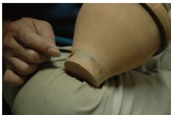
写真 50 割れた型の補修③
