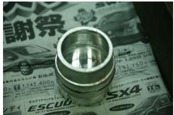
写真78 焼き合わせ部分
