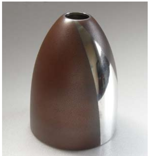
写真 86 サンドブラスターで仕上げた製品
