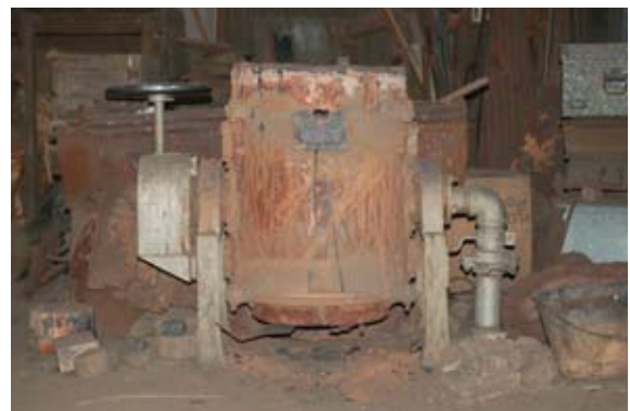
写真43 溶解炉 (坩堝炉)
