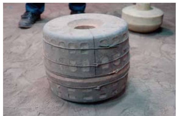
写真18 甲型と尻型を合わせた状態
