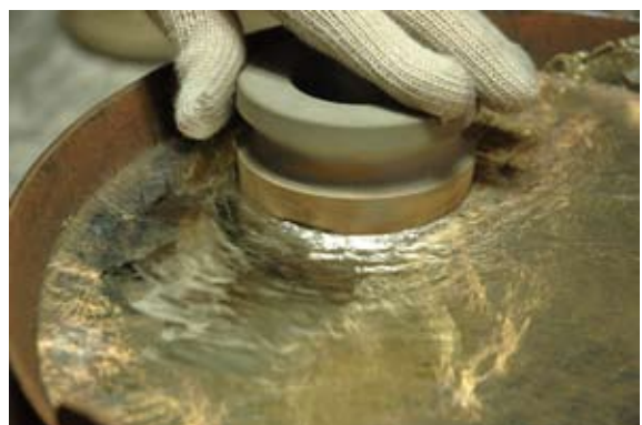
写真 42 中子を浮かせて温める
