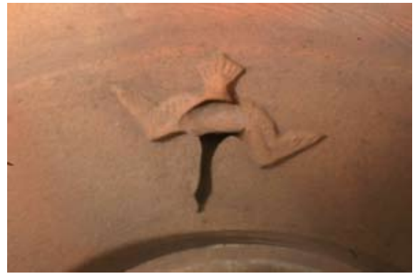
写真 30 外型に埋め込まれた鑲付鑄型
