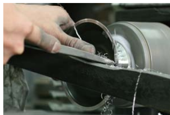
写真 66 中を挽いているところ
