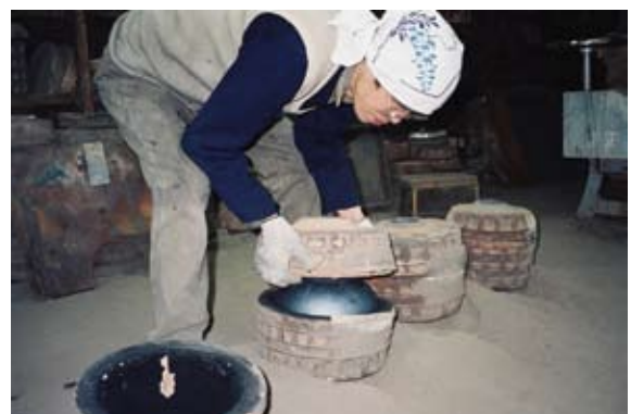
写真48 外型(尻型)を外す
