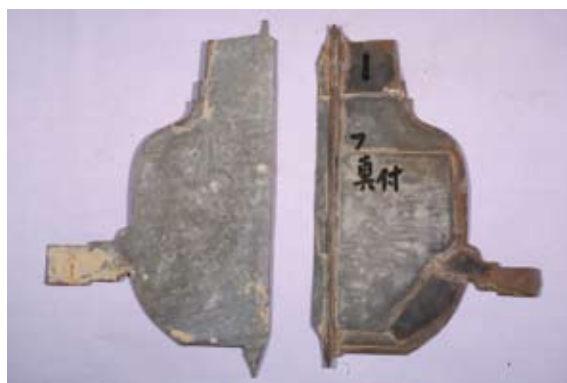
写真 13 鉄板製の木型
