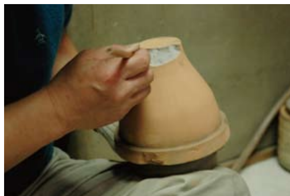
写真 48 割れた型の補修①
