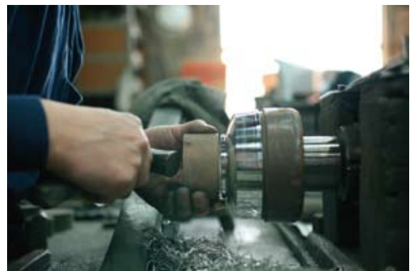
写真63 フリを取る作業
