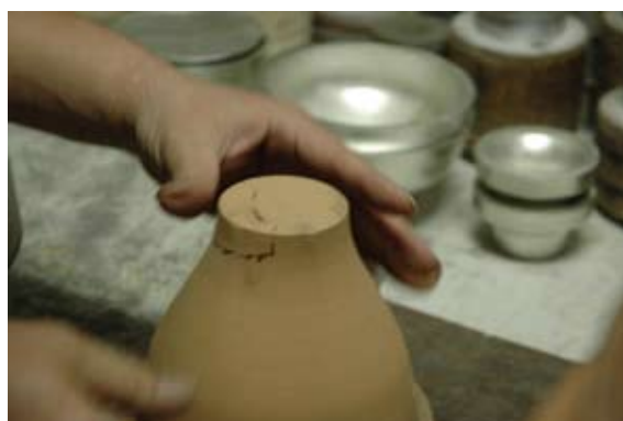
写真 49 割れた型の補修②
