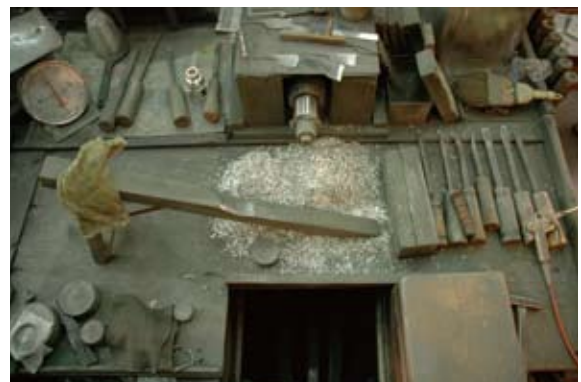
写真54 現在主として使用されている椀型ロクロ
