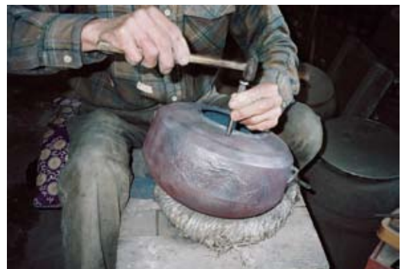
写真 51 焼き締め後タガネ打ち
