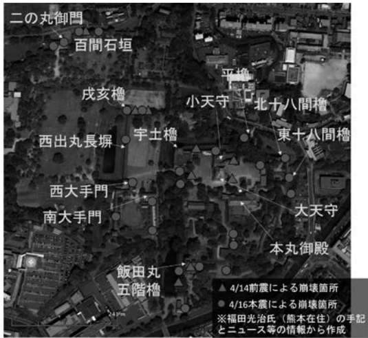
図 2 熊本城石垣の崩壊箇所
