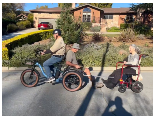
写真-4 eTrike を改造した津波避難ビーイクル (NPO Live Warning 提供)
