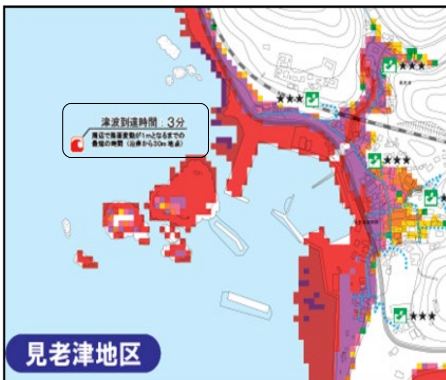
図-3 和歌山県すさみ町の津波ハザードマップ(2024年度末まで使用していたバージョン) 図中の左上 矩形の中に「津波到達時間3分」と明示されている
