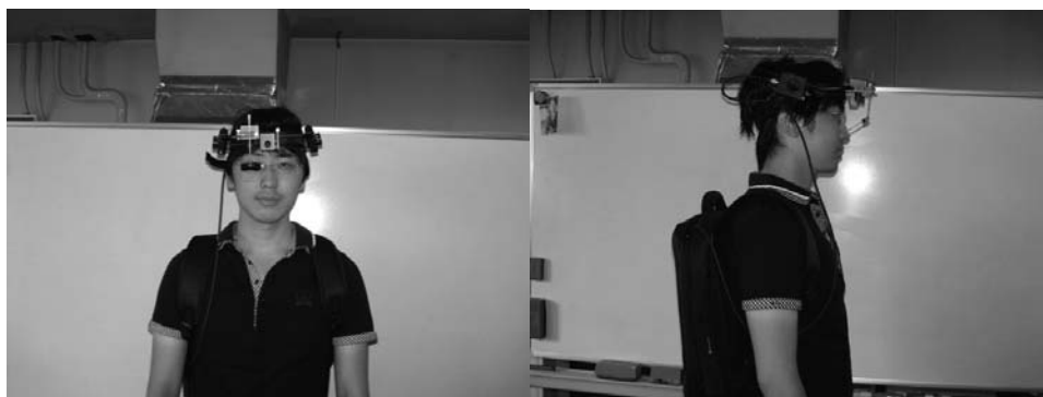
図 2-1a アイマークレコーダの装着(正面) 図 2-1b アイマークレコーダの装着(横)
