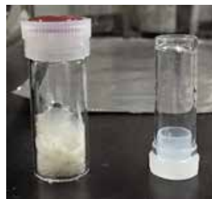
マクロモノマー(左)と生理食塩水を加えて作ったヒドロゲル(右)
